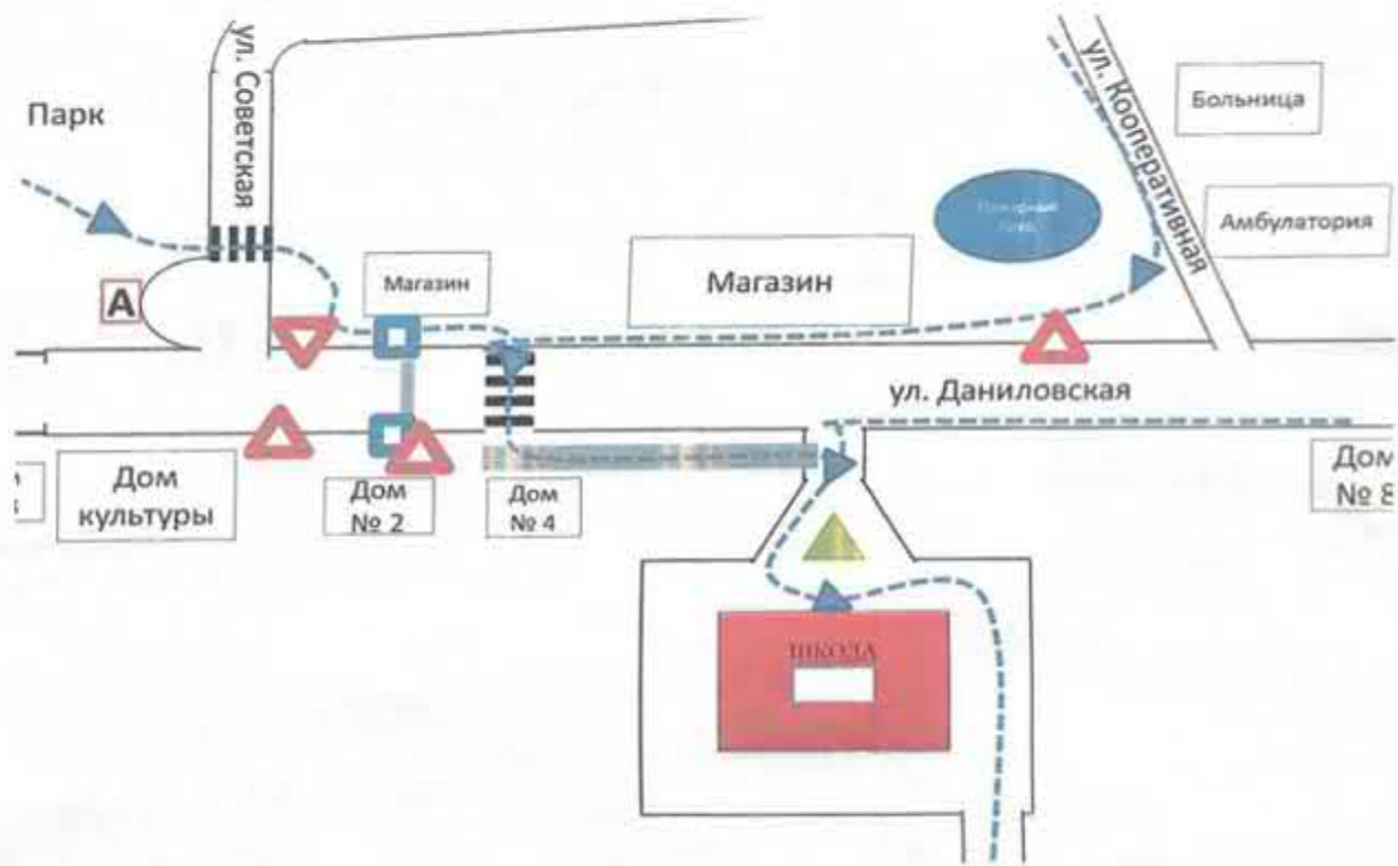
Схема организации дорожного движения в непосредственной близости от образовательного учреждения с размещением соответствующих технических средств, маршруты движения обучающихся (воспитанников) и расположение парковочных мест
